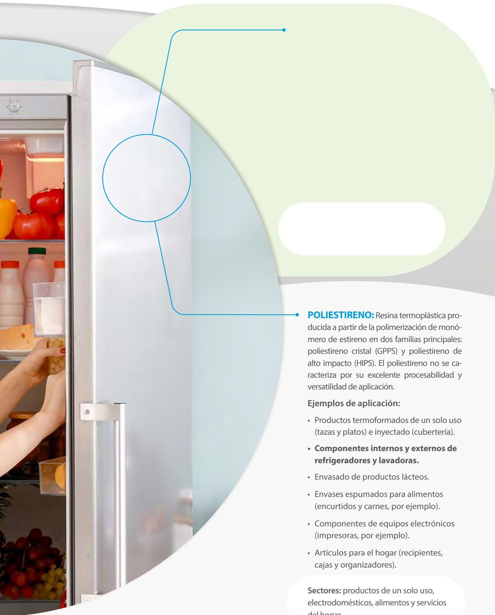
**POLIESTIRENO:** Resina termoplástica producida a partir de la polimerización de monómero de estireno en dos familias principales: poliestireno cristal (GPPS) y poliestireno de alto impacto (HIPS). El poliestireno no se caracteriza por su excelente procesabilidad y versatilidad de aplicación.
